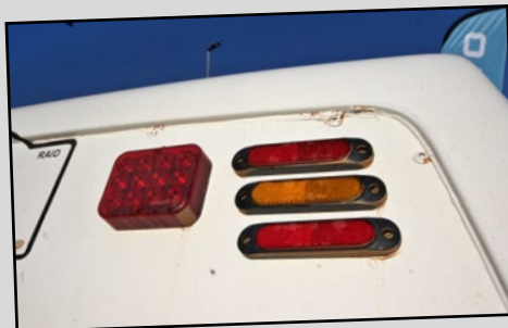
Équipement obligatoire en rallye ! Profitant du remplacement de la lunette arrière par un panneau en aluminium Dibond, Michel y a intégré les feux de course en hauteur.
