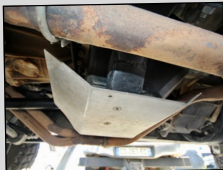
Désormais, la boîte de transfert de ce proto se cache derrière un blindage made in Stand 4x4.
