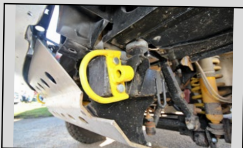
En bout de longerons avant, deux gros anneaux de remorquage ont fait leur apparition.
