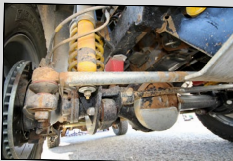
En prévision des pistes du Maroc, les barres de direction et d'accouplement ont été changées par des modèles renforcés.
