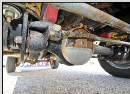
Afin de protéger le nez de pont avant, notre passionné l'a habillé d'une coquille à visser.
