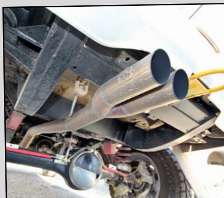
Afin que le V8 évacue mieux les gaz brûlés, le Rangeault reçoit une ligne d'échappement « directe » en Inox, œuvre de la société Ducks Machine.
