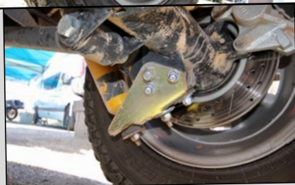
À l'image de l'avant, le Rangeault compte deux amortisseurs OME Nitrocharger par roue à l'arrière. Un montage rendu possible grâce à des pattes de décalage.
