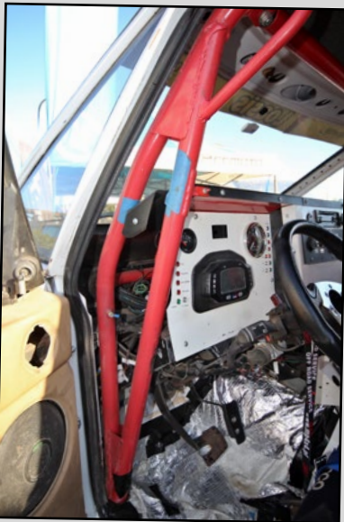
Sécurité oblige, Michel a fabriqué lui-même un arceau de sécurité 8-points à bord.
