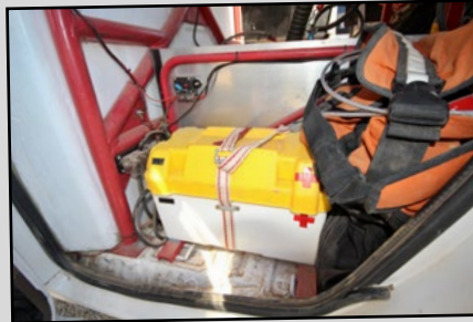
Sur le côté du réservoir d'essence, accessible depuis la porte arrière gauche, ce bac renferme la batterie du Rangeault.
