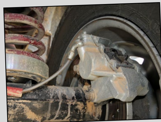
Freinage comme neuf ! Au cours de la gestation de ce proto, notre passionné a changé les étriers de frein par des neufs et les durits par des modèles type « avia ».
