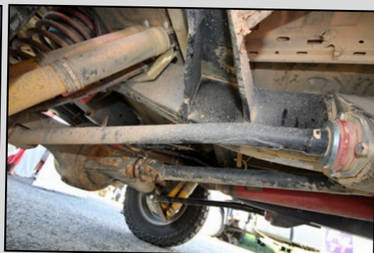
Le pont arrière est désormais maintenu par un jeu de tirants renforcés Raptor 4x4.
