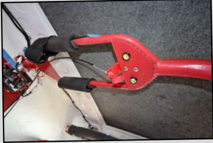
En cas d'accident sur la piste, Michel n'aurait qu'à lever le bras pour attraper ce coupe-circuit installé au plafond.
