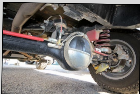
À l'instar du pont avant, l'essieu arrière se pare d'une coquille à visser.
