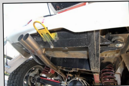
Pour marier la caisse Renault au châssis du Range, l'ami Michel a été dans l'obligation de raccourcir, puis remettre en forme les longerons arrière.
