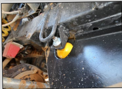
Caché par le ski avant, un amortisseur de direction OME limite les vibrations dans le volant.
