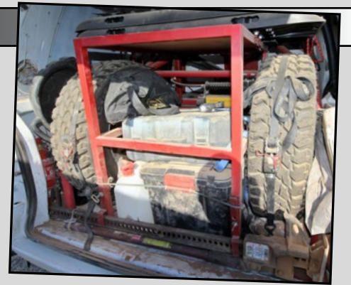
Dans le coffre, notre passionné a installé un grand rack métallique sur lequel sont sanglées deux roues de secours de chaque côté.
