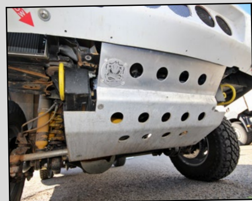
Véhicule unique en son genre, le Rangeault s'habille d'un ski avant fait sur-mesure par la société Ducks Machine.
