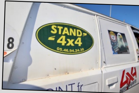
Exit les vitrages arrière ! Michel les a remplacés par des panneaux d'aluminium Dibond.
