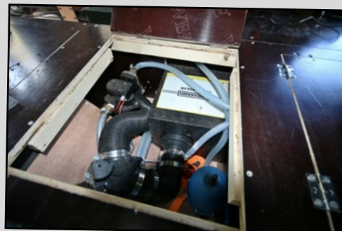
Toujours en prévision de leur périple en pays froid, un chauffe-eau Pundmann de 9 litres prend place à côté du réservoir d'eau de 80 litres.
