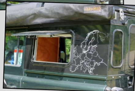
En lieu et place du vitrage latéral gauche, ce 110 s'habille d'un panneau en aluminium Dibond dans lequel est intégré un lanterneau de van s'ouvrant à 90°.
