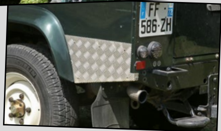
Bien qu'ils disposent d'une caméra de recul Garmin pour les marches arrière, en préventif, Paul et Jade ont quand même habillé les coins des ailes arrière avec ces protections en aluminium strié.
