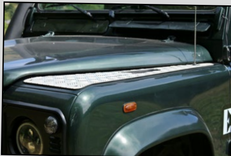
À l'instar des ailes arrière, les dessus des ailes avant s'habillent de protections en aluminium strié.
