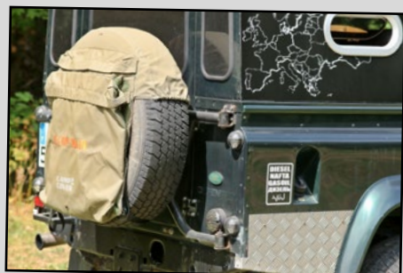
Désormais, la roue de secours trouve place sur un porte-roue indépendant.
