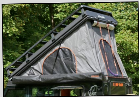
Principal changement subi par ce Land, son toit fixe a disparu au profit de cet Icarus abritant un couchage de 237 x 125 cm.
