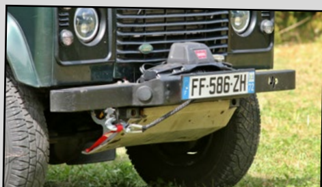
Exit le pare-chocs d'origine ! En lieu et place, ce Defender reçoit un modèle Heavy Duty.
