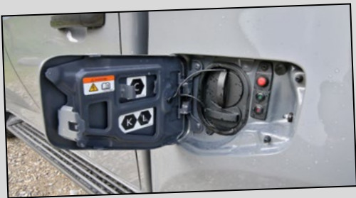
En lieu et place de la goulotte de remplissage du réservoir, vous trouvez les ports de charge du D-Max EV
