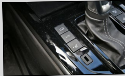
Mode bien pratique pour l'autonomie! En appuyant sur le bouton Eco, vous bridez légèrement les performances des deux moteurs électriques pour gagner en distance à parcourir.
