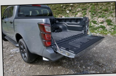
Comme un N60 turbodiesel, le D-Max EV bénéficie de la même capacité de charge de 1000 kg et sa benne offre les mêmes dimensions intérieures.
