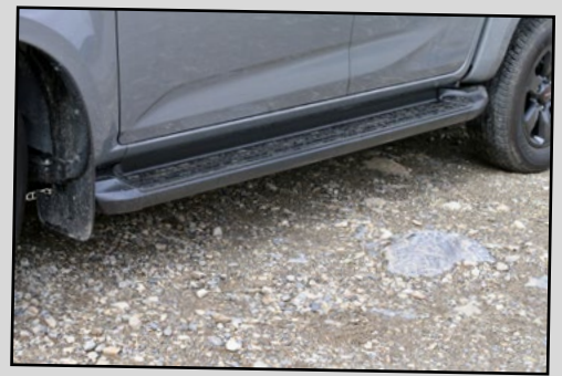
Comme sur les N60 thermiques, l'accès à bord est facilité par ce jeu de marchepieds.
