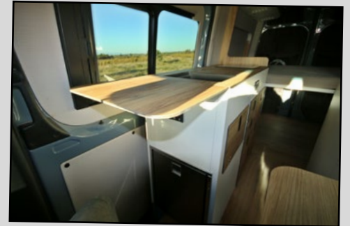
Histoire de cuisiner à votre aise à bord, le meuble « cuisine » intègre une tablette basculante permettant d'agrandir le plan de travail.
