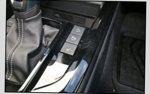
Preuve que le D-Max EV est destiné à un usage offroad! Sur le côté droit du tunnel de boîte, vous disposez d'un bouton actionnant le limiteur de vitesse en descente et un autre désactivant les capteurs de proximité.
