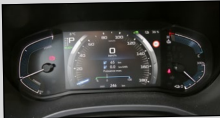
De part et d'autre du compteur de vitesse, vous disposez de quatre jauges. Une indique la charge restante de la batterie, la seconde sa température, la troisième vous informe de la puissance délivrée aux deux moteurs et la dernière vous renseigne sur la force restituée par le freinage régénératif.
