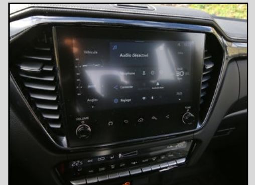
Au centre de la planche de bord, comme sur ses congénères à moteur turbodiesel, un écran tactile multimédia de 9 pouces permet de contrôler le système d'infodivertissement.
