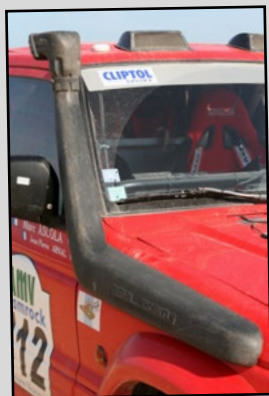
Afin d'éviter toute poussière dans le circuit d'admission, un snorkel coiffe l'aile avant.
