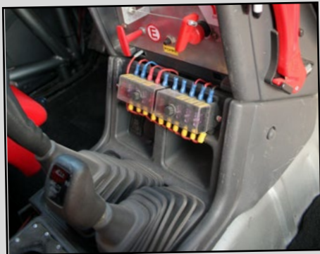
Au centre de la console se trouvent le coupe-circuit général, la commande d'extincteur automatique, les fusibles, la manette du système Sentinel...
