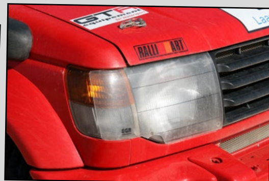
Les phares s'abritent désormais derrière des protections EGR.
