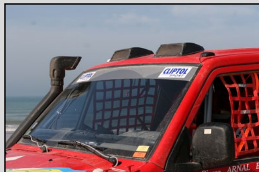
Afin d'assurer une bonne ventilation, deux prises d'air prennent place sur le toit.
