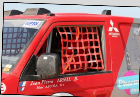
Obligatoire en rallye-raid, des filets anti-défenestration sont fixés à l'avant.
