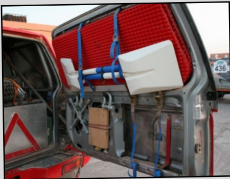
Tout à portée de main! La porte arrière sert de rangement à deux jeux de plaques de désensablage, un jeu de pelle et l'outillage.
