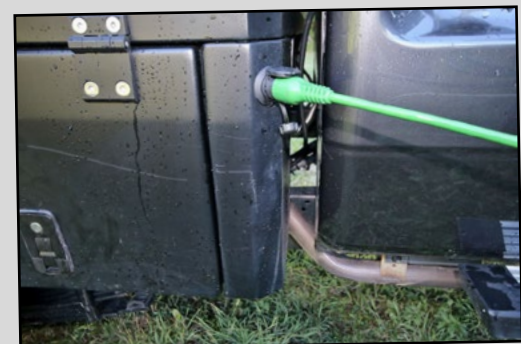
En prévision des bivouacs «longue durée», cette prise de quai permet d'alimenter la cellule en courant domestique.
