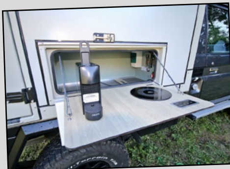
Pour profiter de la cuisine extérieure, il suffit de sortir cette tablette amovible dans laquelle est incorporée une plaque de cuisson à induction.
