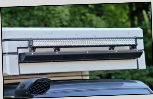
À l'avant de la cellule, sur sa capucine, une barre Lazer Tripe-R Elite apporte un regain de luminosité sur les pistes la nuit.
