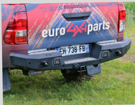
Exit le modèle d'origine jugé trop fragile pour le TT ! En lieu et place, cet Hilux s'habille d'un pare-chocs arrière Rival conçu en aluminium de 6 mm.
