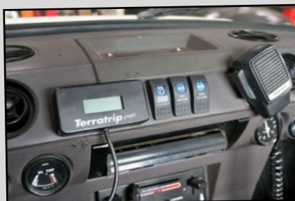
Au centre de la console, vous retrouvez les commandes des deux blocages ARB.
