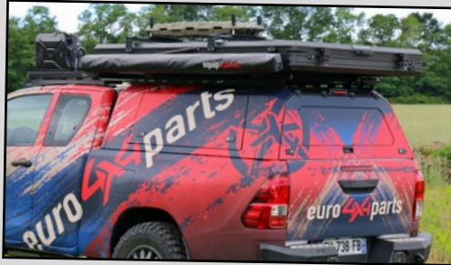
Pas encore commercialisé ! L'une des particularités de ce show-car est qu'un prototype de hard-top métallique ferme sa benne. Fabriqué en acier inoxydable, ce dernier peut supporter jusqu'à 150 kilos en dynamique et 350 kilos en statique.
