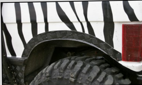
Afin que les roues ne frottent pas contre, le pourtour des ailes avant et arrière a été raccourci de quelques centimètres.
