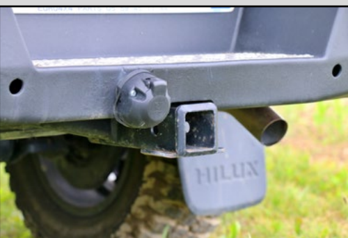
Grâce à ce carré américain intégré au pare-chocs Rival, il est possible d'ajouter un attelage amovible sur cet Hilux.
