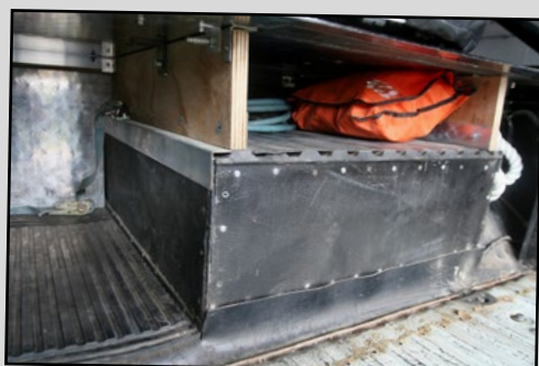
Le réservoir d'origine du Range a été relogé dans la benne, dans ce caisson métallique.
