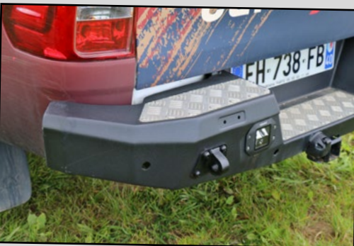
De par sa forme, le pare-chocs arrière Rival facilite l'accès à la benne, voire au-dessus du hard-top, car il a été dessiné pour qu'on puisse prendre appui dessus.
