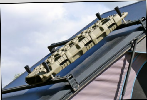
Sur le dessus de la tente Equip'Addict, une paire de barres de toit accueille un jeu de plaques de désensablage.
