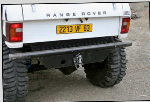
Une traverse faite maison rigidifie les longerons arrière après leur amputation. À sa suite, un pare-chocs tubulaire protège les ailes.
