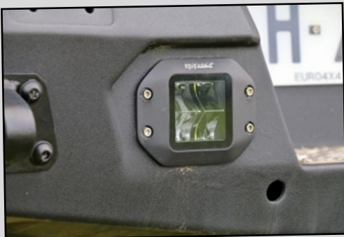
Histoire de bien appréhender les obstacles lors d'une marche arrière nocturne, le pare-chocs arrière Rival est équipé d'une paire d'antibrouillards encastrables Equip'Addict.
